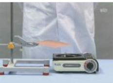
鉄製スタンドにろうを塗った金属板を固定し、実験用ガスコンロを金属板の角に炎があたるように置きます。
