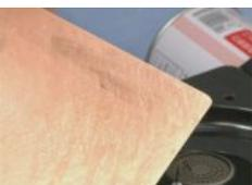
実験用ガスコンロで金属板を熱し、ろうが溶けるようすを調べます。
