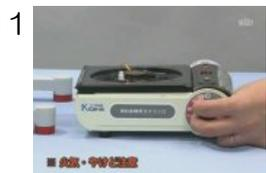
11 実験用ガスコンロの火を消します。
