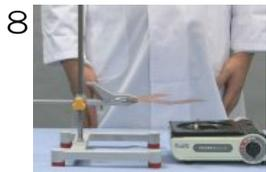
8 鉄製スタンドにろうを塗ったコの字型の金属板を固定し、実験用ガスコンロを金属板の角に炎があたるように置きます。
