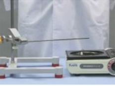
鉄製スタンドにろうを塗った鉄棒を固定し、実験用ガスコンロを棒の端に炎があたるように置きます。
