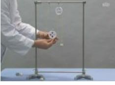
滑車をもうひとつ追加して糸を通し、滑車の重さを補正するために釣合分銅をつりさげます。
