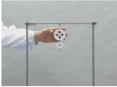
9 複滑車に糸をかけ、複滑車の重さを補正するために釣合分銅をつりさげます。
