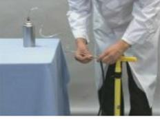
空気ポンプにチューブを接続し、スプレー缶に空気を入れます。
