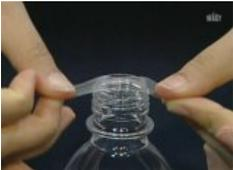
ペットボトルの口にプレパラートをセロハンテープで固定します。
